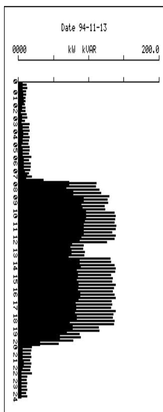
Exemple d'impression de l'histogramme journalier de puissance moyenne (sur 15') Cet histogramme s'imprime automatiquement à minuit.
